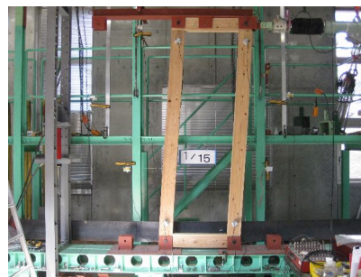
リブフレームの水平加力実験 (福山大学鎌田研究室)
